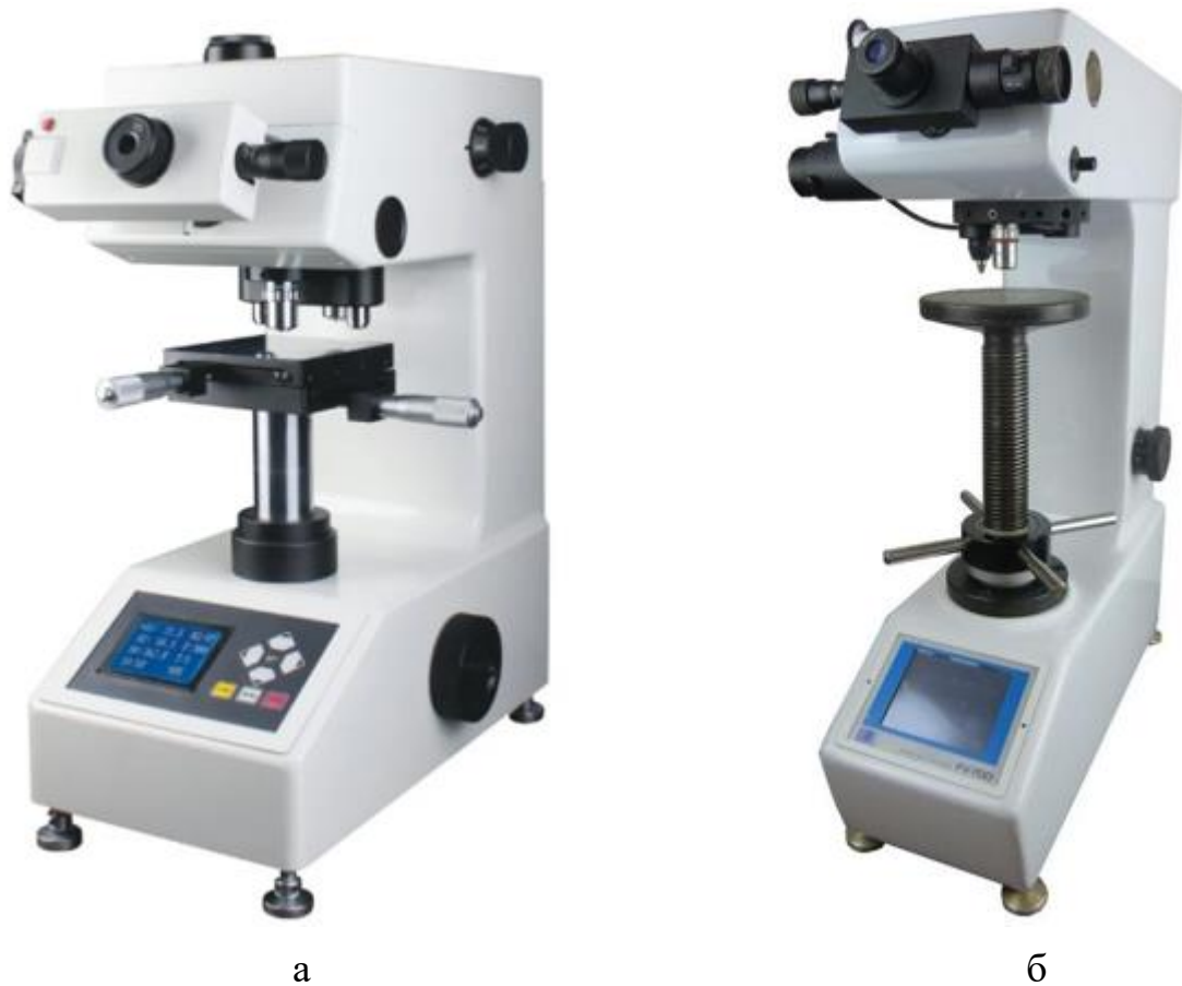
Рисунок 2.9 – Мікротвердоміри: а – MHV-1000; б – FV-700
