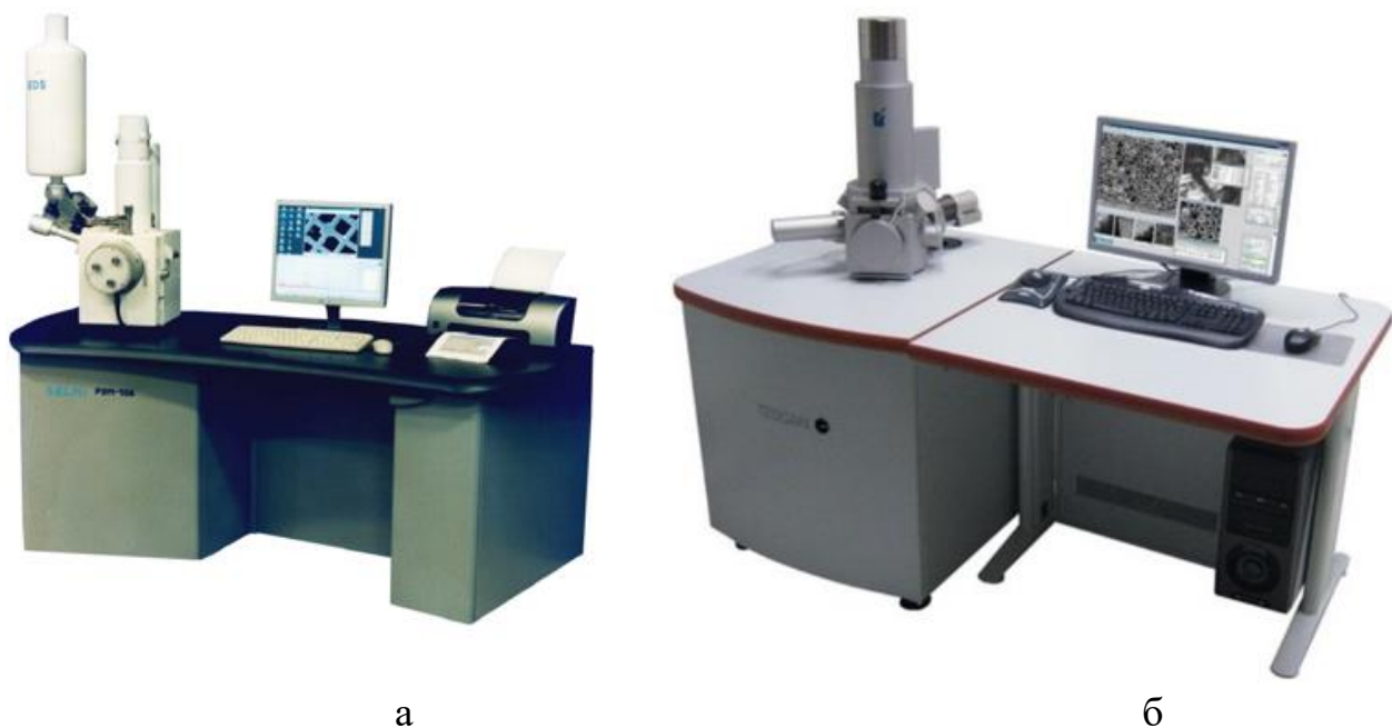
Рисунок 2.6 – Растрові електронні мікроскопи: а – Selmi РЭМ 106; б – TESCAN VEGA 3
