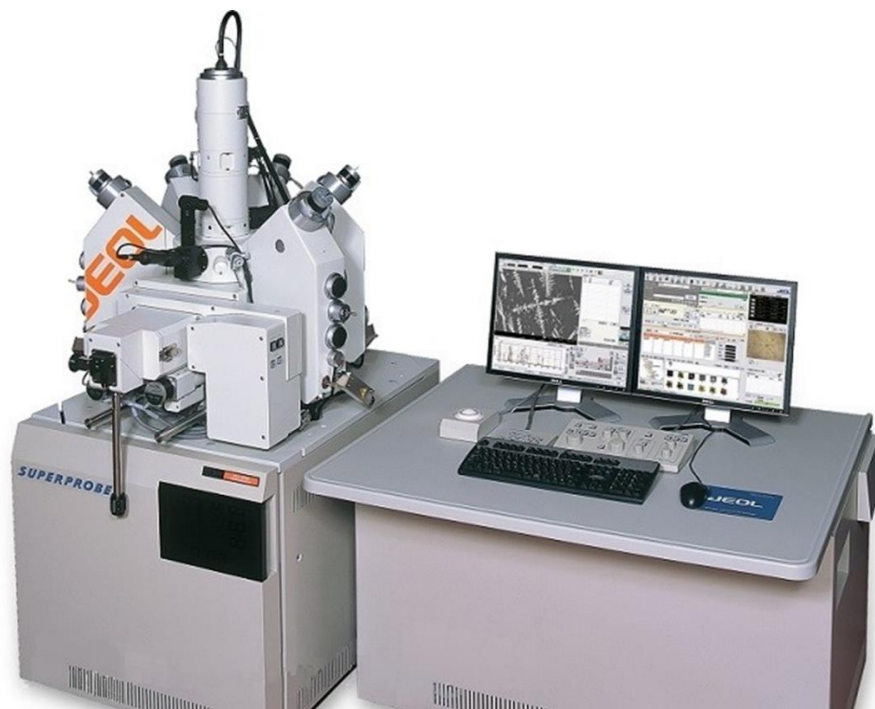
Рисунок 2.7 – Рентгеноспектральний мікроаналізатор JXA-8530F
