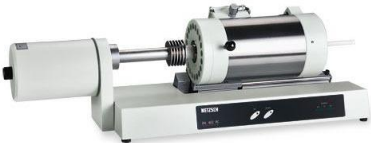
Рисунок 2.13 – Дилатометр DIL 402C/7
