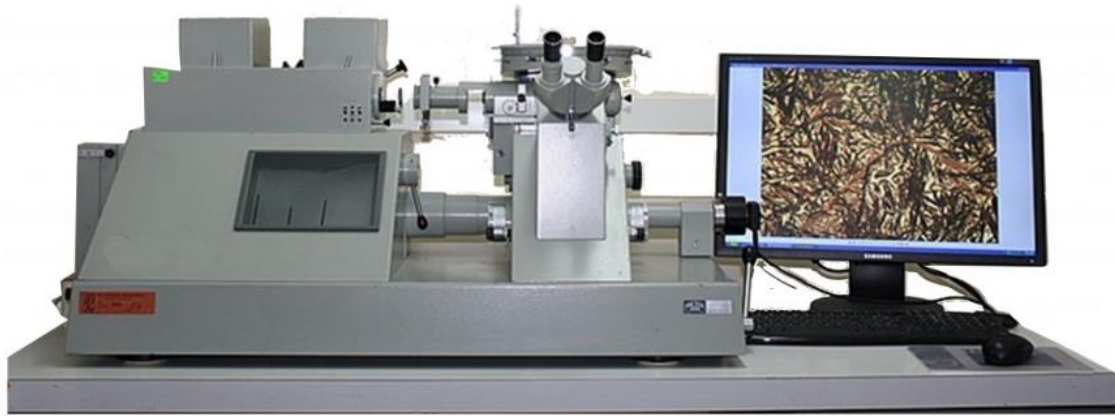
Рисунок 2.5 – Оптичний мікроскоп Neophot 21
